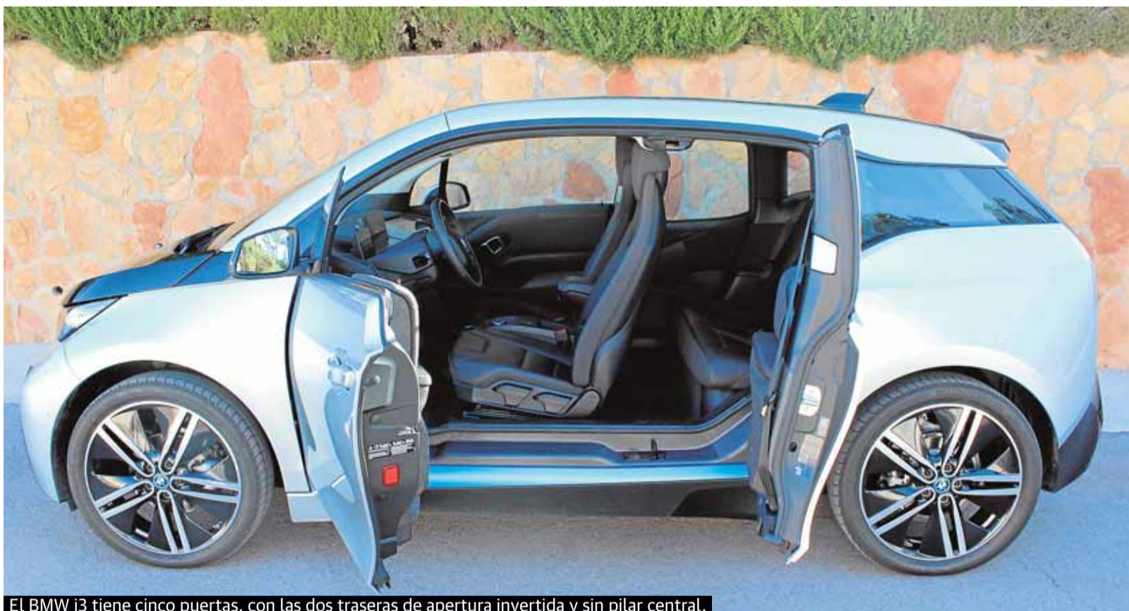
El BMW i3 tiene cinco puertas, con las dos traseras de apertura invertida y sin pilar central.
