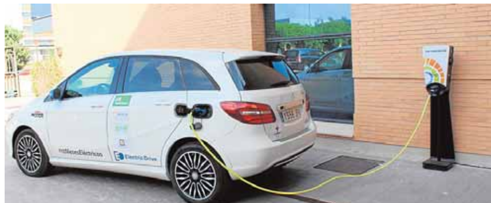
Fácil recarga, completa en menos de tres horas con una toma del tipo Mennekes.
